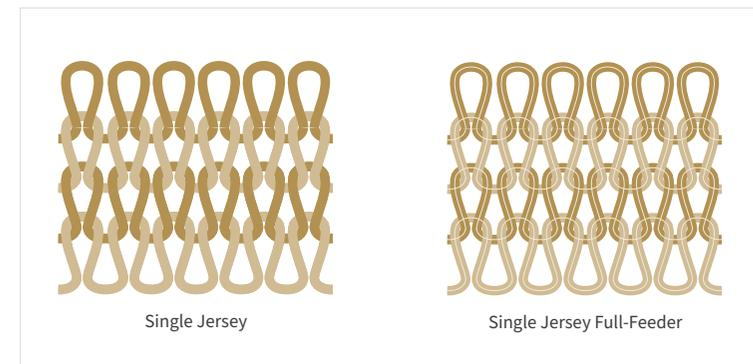
Für zusätzlichen Komfort durch höhere Elastizität, kann der Strickmaschine gemeinsam mit dem Baumwollgarn ein Elasthanfilament zugeführt werden. Je nachdem ob dies in jedem oder jedem zweiten Maschenstäbchen geschieht, spricht man von einer „Half-“ oder einer „Full-Feeder“-Technologie. Letztere generiert die gleichmäßigere Verteilung des Elasthans und somit den hochwertigeren Stoff.
